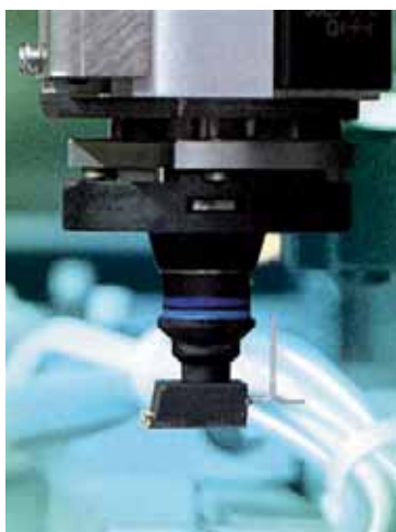
Fig. 2 - Preformatura e montaggio SMT Mosfet
