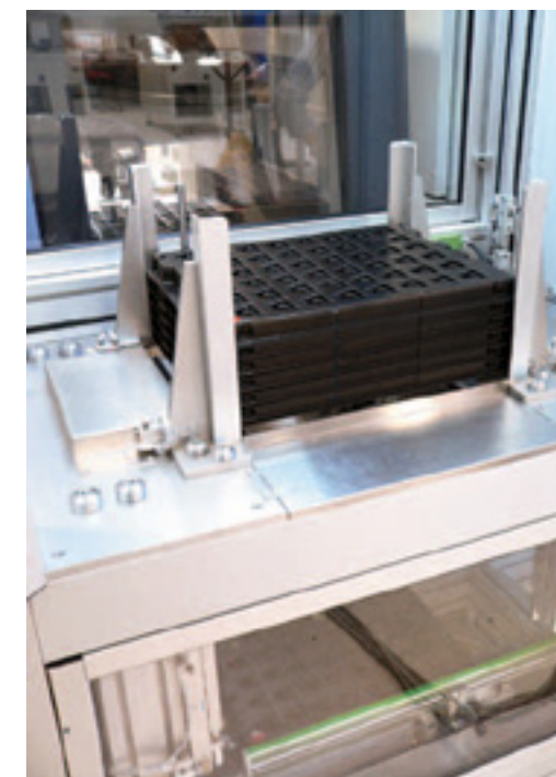
Il magazzino della neorouter modula
