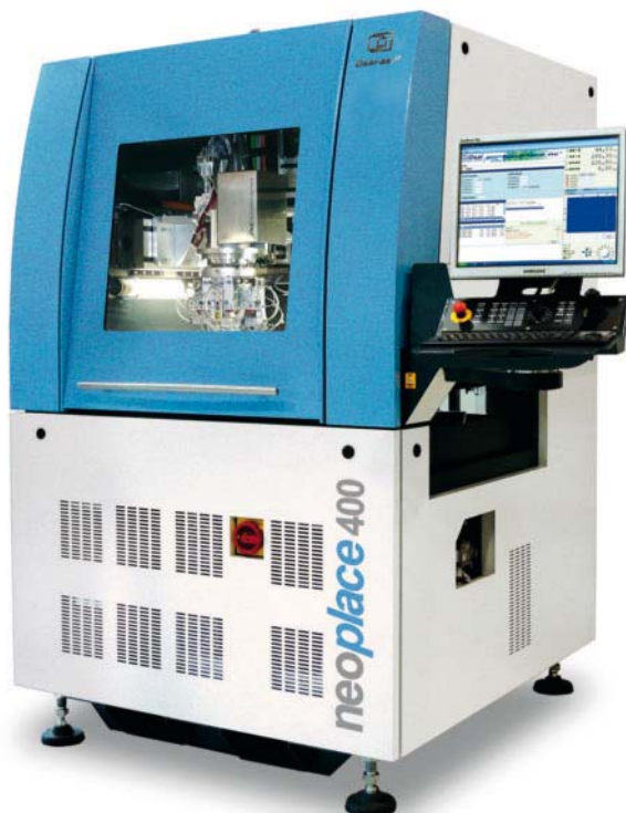
1 Neoplace 400 von Osai ist ein schnelles und präzises Montagesystem für Odd-Form- und Standard-Komponenten in der Leiterplattenbestückung
