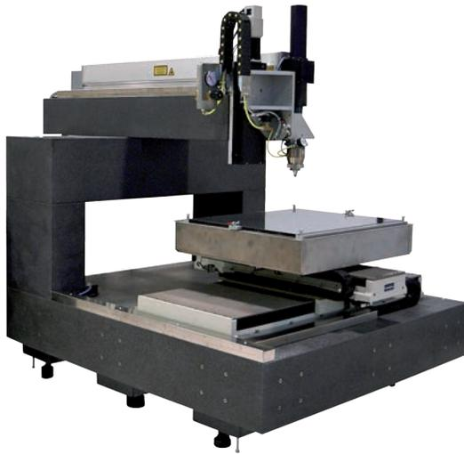
Finecut 130HP ist ein kompaktes **System "all in one"** zum **Schneiden von metallischen Bauteilen**, einschließlich der Laserquelle. Es wird oft mit einem Arbeitstisch mit Fernbedienung kombiniert, um Schneidprogramme auszuwählen/zuschreiben.
