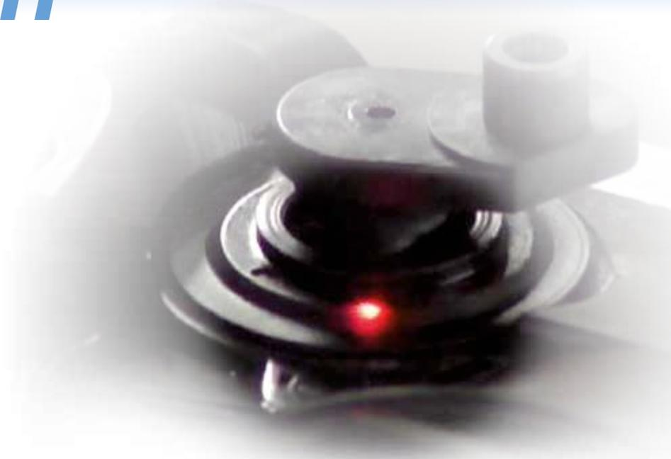
Beim Laserschweißen von Polymeren im Durchstrahlverfahren werden zwei Kunststoffe mit unterschiedlichen Absorptionseigenschaften, im Überlappstoß verschweißt. Die zu fügenden Kunststoffteile liegen übereinander und die Laserstrahlung wird durch den für die Laserwellenlänge transparenten Kunststoff hindurch auf das absorbierende Material fokussiert, wodurch es oberflächlich aufschmilzt. Über Wärmeleitung wird auch das transparente Material geschmolzen, so dass es zu einer Verbindung kommt.
