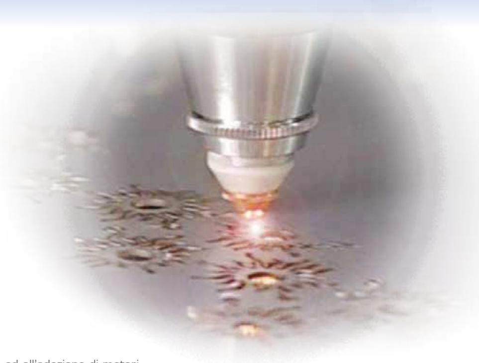
Stazione di taglio LASER, sviluppata per i mercati della gioielleria e della moda. Ideale per produzioni di serie, ma anche per la prototipazione e la creazione di pre-serie. Ampia gamma di materiali idonei al taglio: oro, alpacca, titanio, alluminio, acciaio, rame, ottone con spessori fino a 5 mm.
