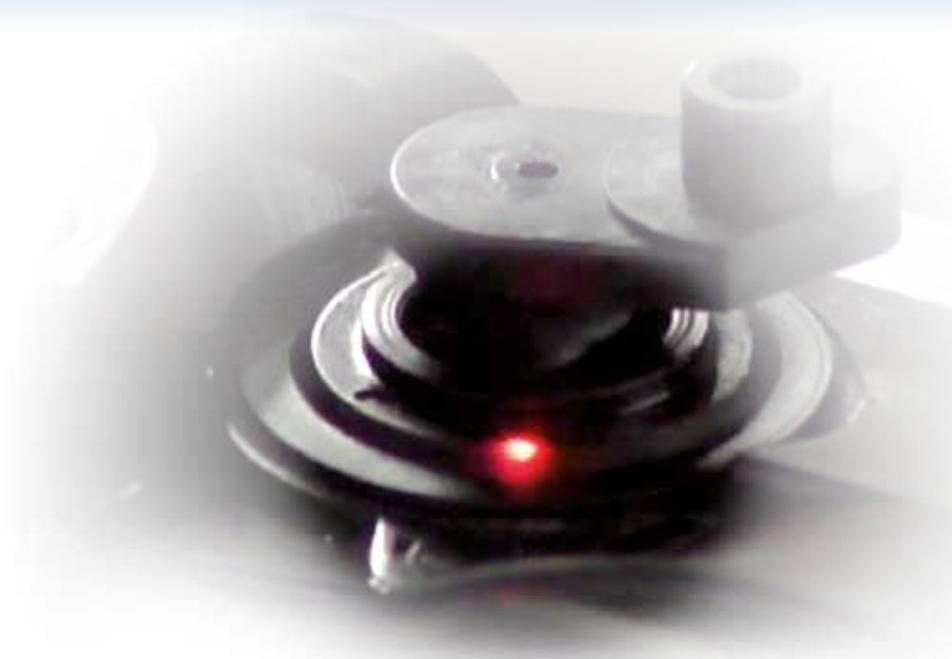
La saldatura LASER di polimeri si effettua mettendo a contatto un materiale trasparente ed uno assorbente; il fascio LASER attraversa il primo e scalda il secondo fino al suo punto di fusione; per contatto anche il materiale trasparente viene fuso e in questo modo si realizza la saldatura.
